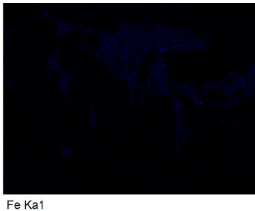
Figura 22 -Imagem do Fe aderido na ferramenta 6
