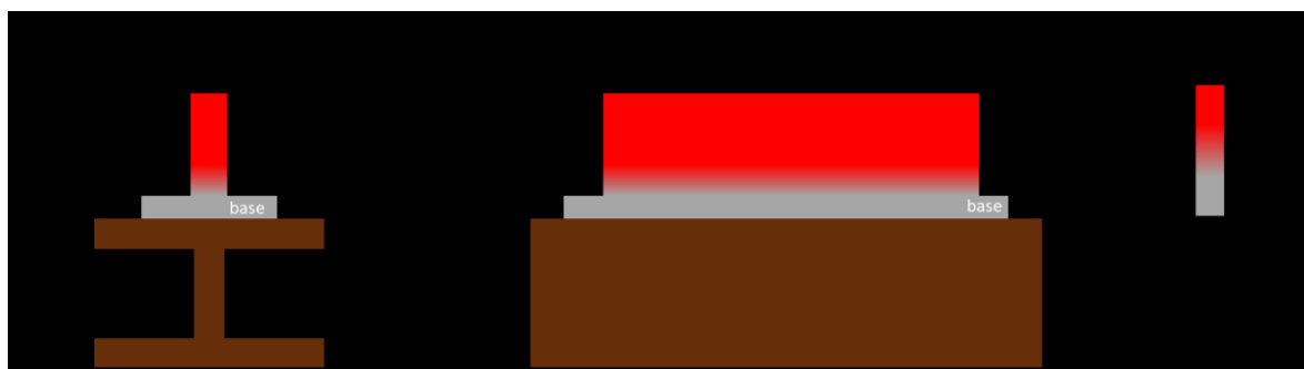
Figura 27 - Ilustração campo de temperatura para resfriamento sem água.
