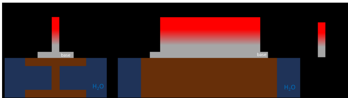
Figura 28 - Ilustração campo de temperatura para resfriamento com água até o suporte.
