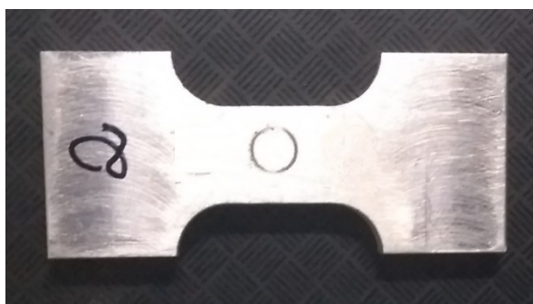
Figura 26 - CP de tração finalizado com referência circular para cálculo de deformação.
