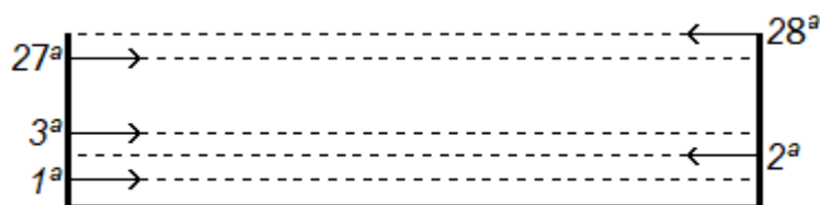
Figura 17- Esquema de deposição das camadas.
