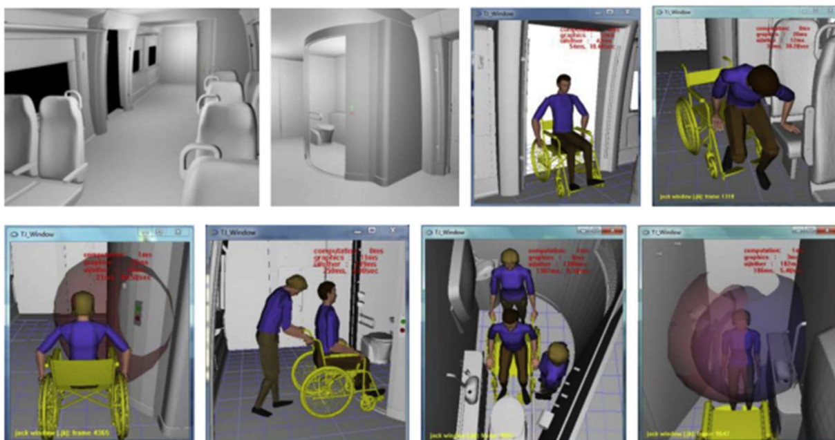
Figura 2: Análise de simulação de ergonomia/fatores humanos do esquema de projeto (Xiang et al., 2018).
