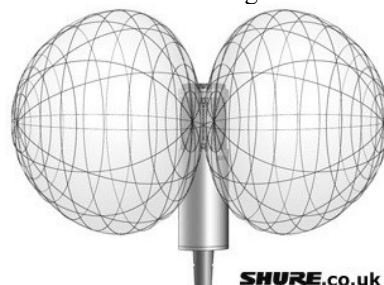
Figura 12 – Diagrama Polar do microfone bidirecional/Figura 8
