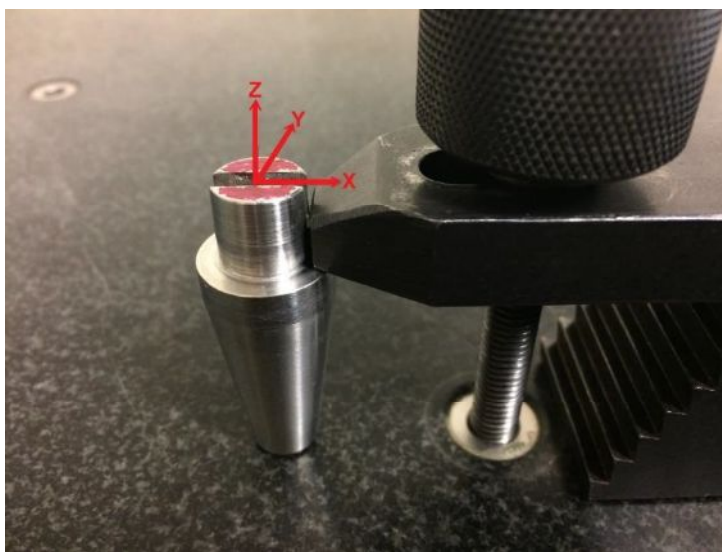
Figura 3.9 - Origem do sistema de coordenadas do corpo de prova 3.
