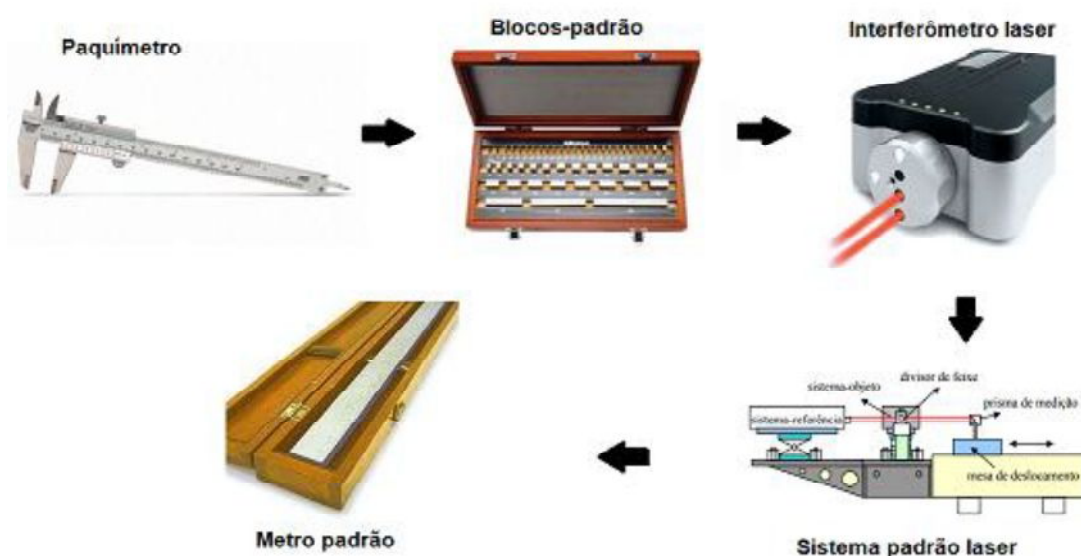
Figura 2.1 - Cadeia de rastreabilidade de um paquímetro.
