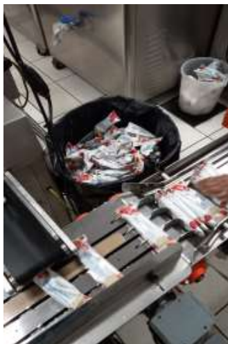
Figura 20 – Evidência de Perda de embalagens
