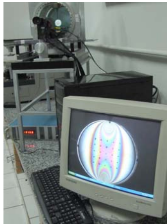
Figura 6.18 – Arranjo do Polariscópio Portátil, indicador de carga, computador e câmera para aquisição da imagem dos modelos sob carga.
