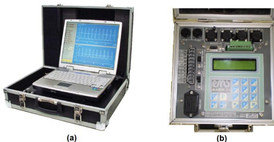
Figura 4.3 – Equipamentos de medição utilizados nos ensaios: a) sistema de aquisição de dados SAP 4.0 da IMC Soldagem; e b) analisador de energia - RMS MARCH-21
