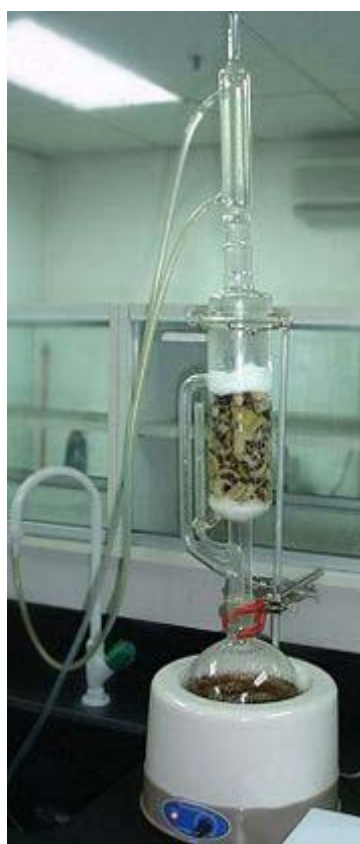
Figura 10: Montagem para extração contínua utilizando o aparelho de Soxhlet.
