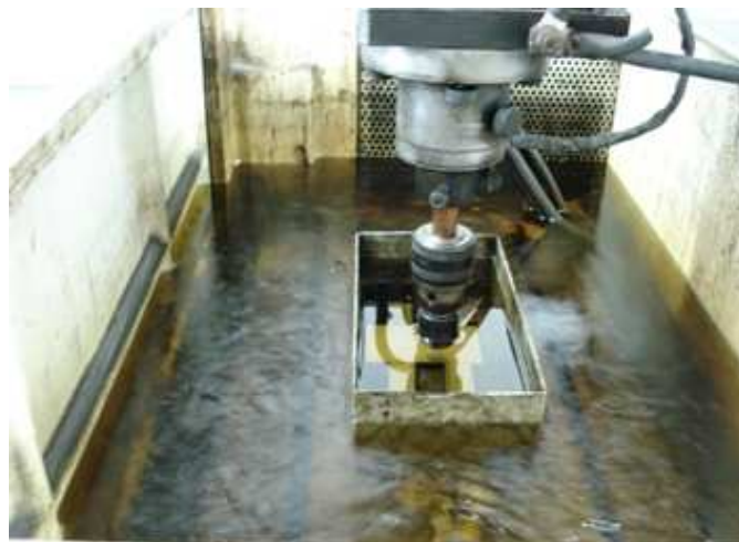
Figura 4.2 – Detalhe da caixa adaptada à máquina de eletroerosão.
