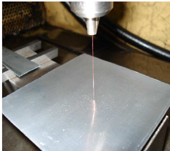
Figura 4.1 – Testes preliminares para confecção dos padrões na máquina de eletroerosão.
