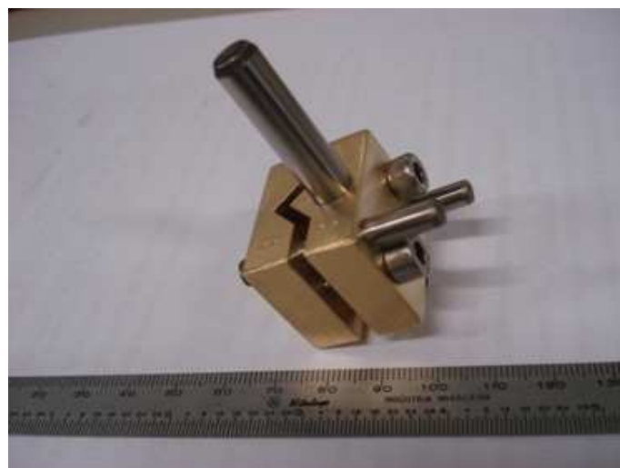
Figura 4.7 – Detalhe do dispositivo de fixação dos eletrodos de eletroerosão.
