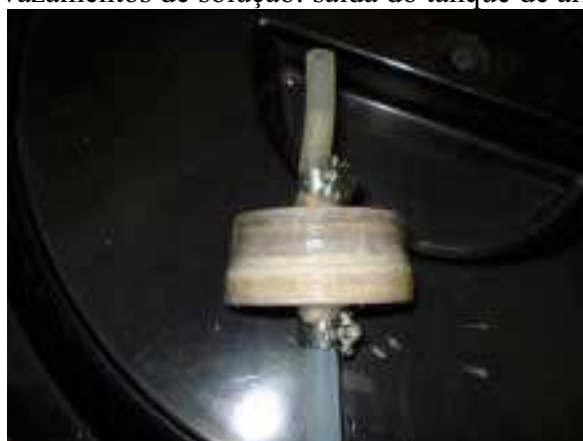
Figura 7.32 - Filtro de partículas: bolhas no sistema.
