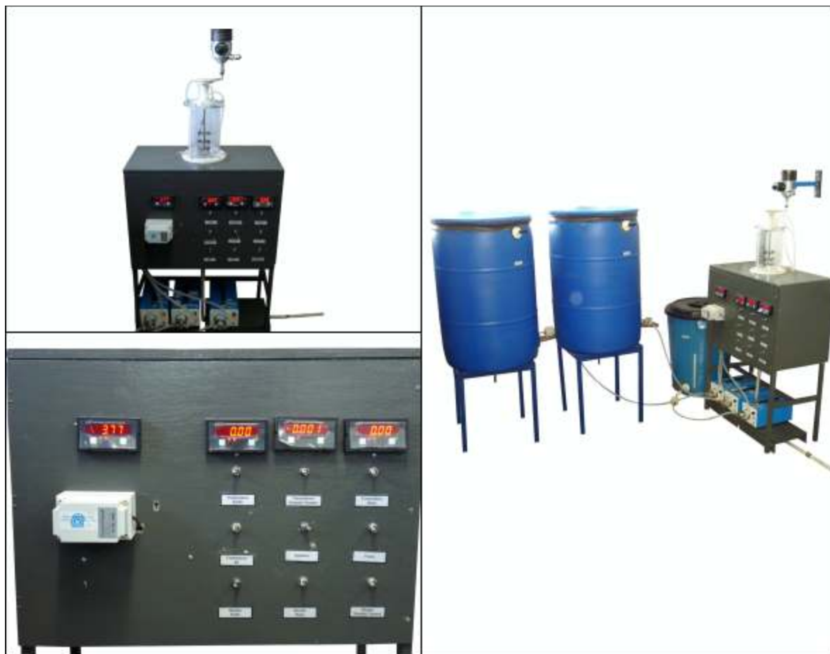
Figura 5.2 - Foto do sistema de neutralização.
