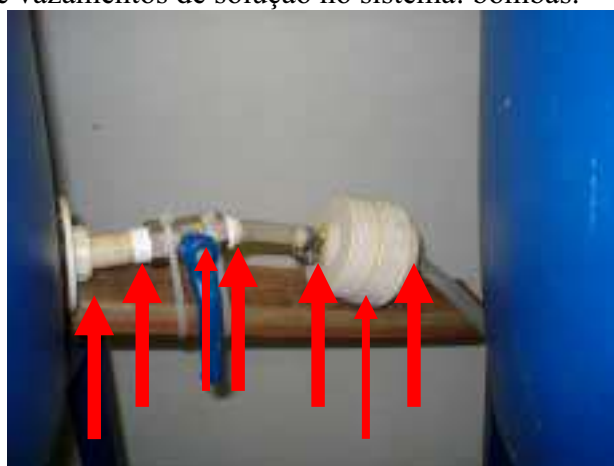
Figura 7.30 - Pontos de vazamentos de solução no sistema: bombas.
