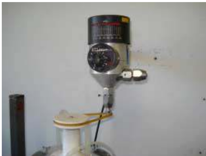
Figura 7.29 - Motor do agitador: fonte de ruídos no sistema.
