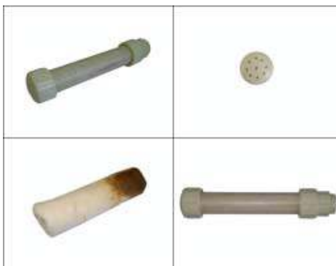
Figura 5.3 - Filtro adaptado no sistema de enchimento de água nos tanques.
