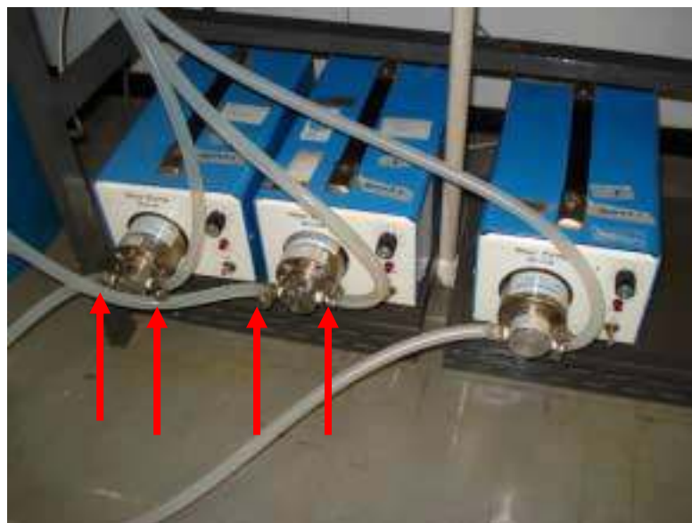
Figura 7.30 - Pontos de vazamentos de solução no sistema: bombas.
