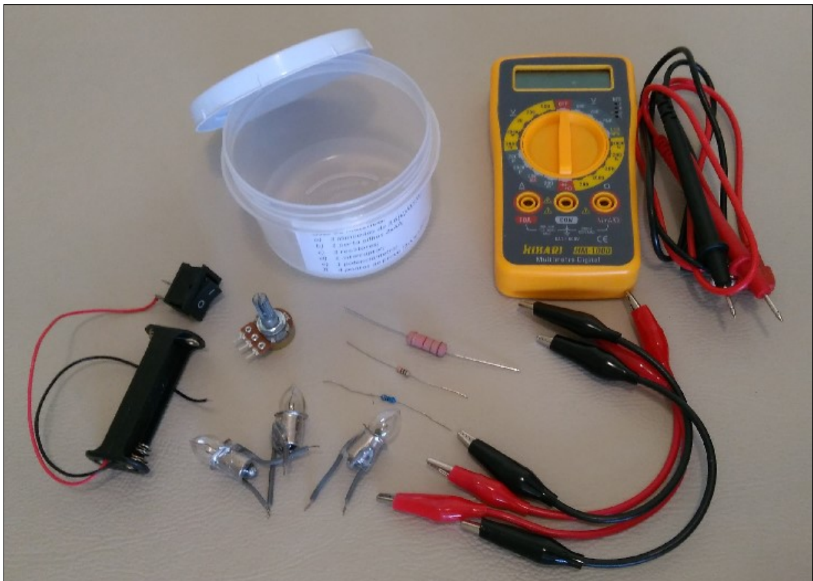
Figura 11 - Componentes do Kit de Circuitos Elétricos
