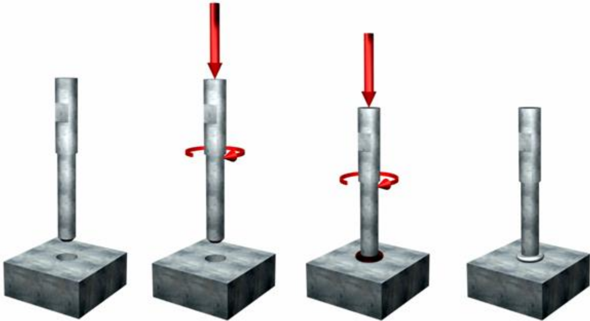
Figura 2.10 - Ilustração esquemática de reparo por atrito com pino cilíndrico (MEYER, 2003).
