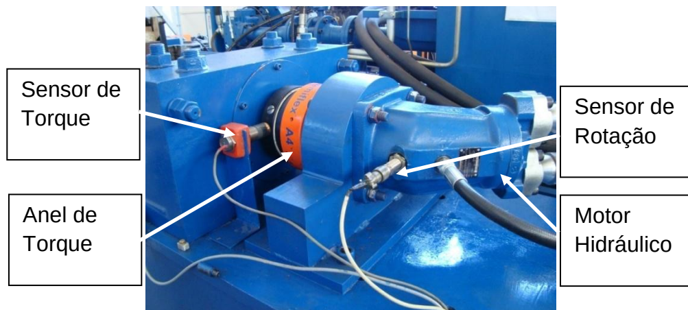
Figura 3.3 – Sensor de rotação acoplado ao motor hidráulico e sensor de torque próximo ao anel de torque.
