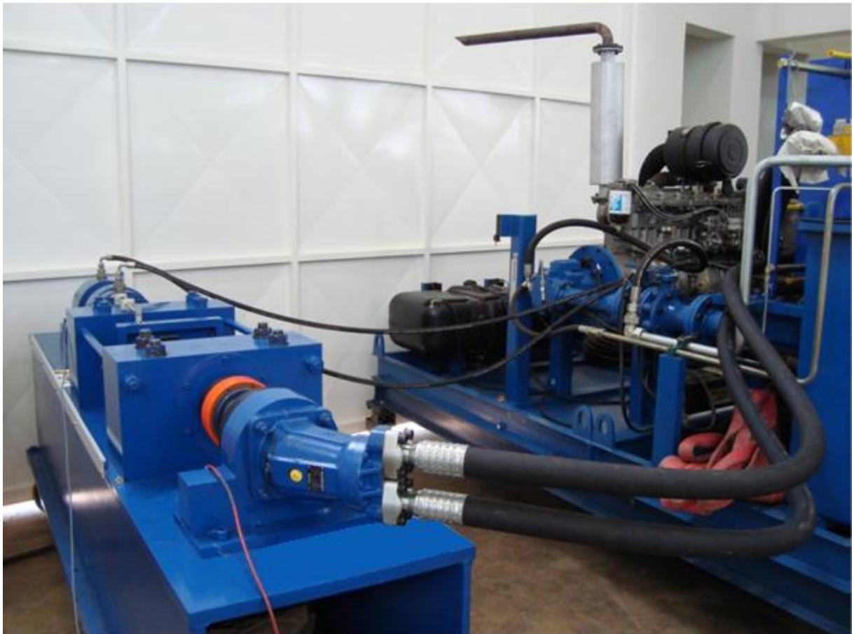
Figura 3.2 – Posicionamento das mangueiras de alta pressão conectadas ao motor e ao cilindro hidráulico (MAREGA, 2011).
