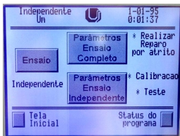
Figura 3.4 – Interface Homem Máquina (IHM), para configuração de processamento (MAREGA, 2011).
