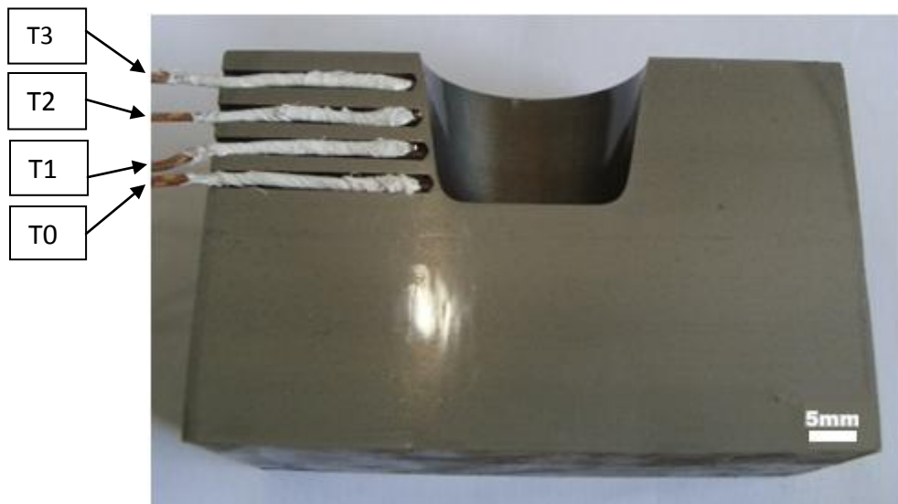
Figura 3.7 – Bloco cortado mostrando o posicionamento dos termopares dentro dos furos, onde T0 é a temperatura do fundo do furo, T1 é a temperatura intermediária 1, T2 é a temperatura intermediária 2 e T3 é a temperatura do topo.
