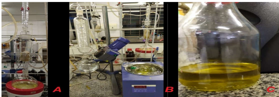
Figura 12 - Sistema de extração do óleo das sementes utilizando extrator Soxhlet (A); evaporador rotativo para recuperação do solvente (B); e o óleo bruto de moringa obtido (C).
