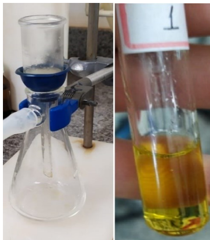
Figura 16 - Sistema de filtração em funil de placa sinterizada revestida com sílica (esq.) e ésteres etílicos obtidos após todos processos (dir.).
