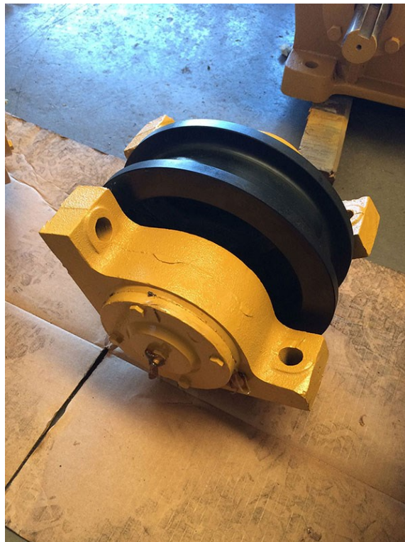
Figura 6 – Exemplo de rodas para pontes rolantes
