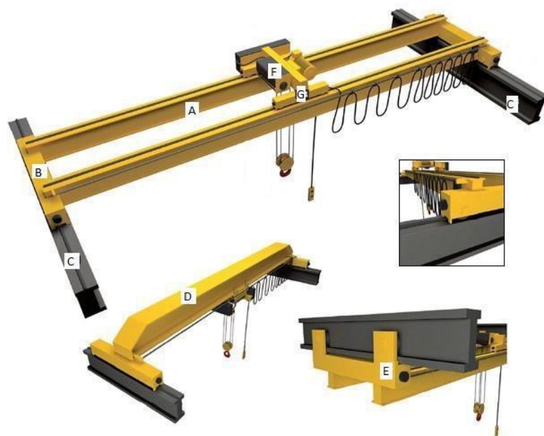
Figura 10 – Alguns componentes de uma ponte rolante
