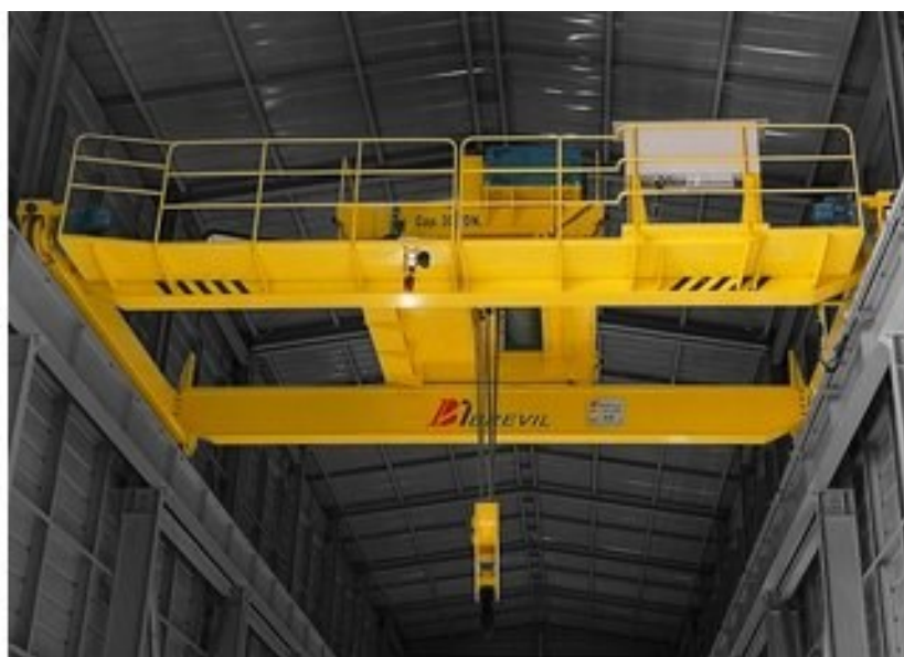
Figura 3 – Exemplo de ponte rolante bi-viga
