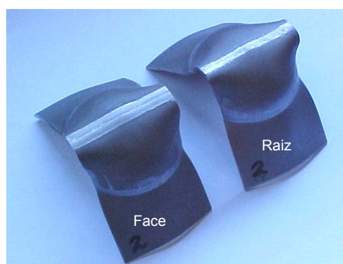
Face e raiz da solda com a mistura A100
