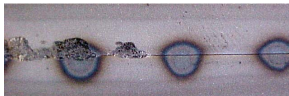
Figura 17.8: Falta de fusão na raiz típica dos cordões obtidos na série 43-1
