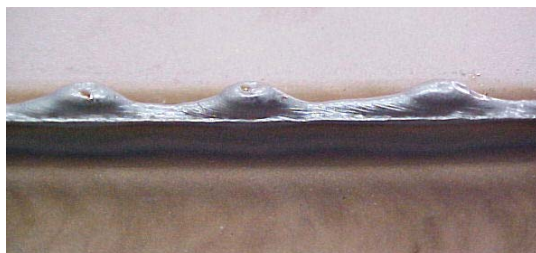
Figura 12.5: Aspecto dos cordões obtidos com MIG/MAG na série de testes 31-2
