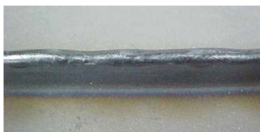
Figura 12.1: Aspecto do cordão obtido com TIG na velocidade limite de 600 mm/min
