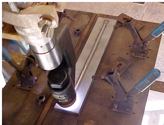
Figura 18.1: Aspecto dos cordões de solda produzidos nas séries de testes deste capítulo
