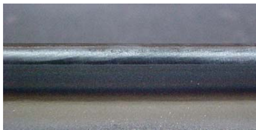
Figura 14.2: Cordão obtido no limite da velocidade de soldagem da série 33-2
