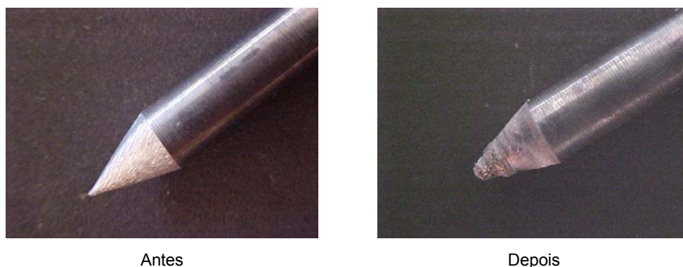
Figura 18.3 Eletrodo antes e depois da série de testes 45-2
