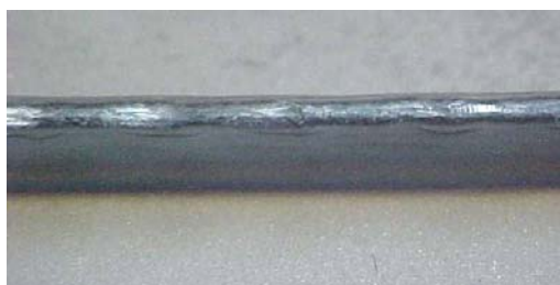
Figura 12.2: Aspecto do cordão obtido com TIG na velocidade limite de 700 mm/min
