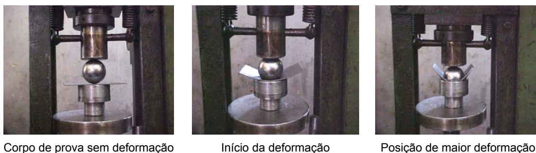
Figura 13.13: Sequência de execução do teste de estampabilidade
