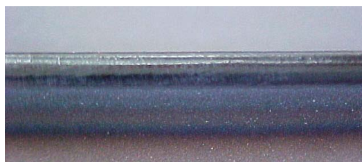
Figura 15.2: Aspecto dos cordões obtidos com a mistura A50C50 à máxima velocidade
