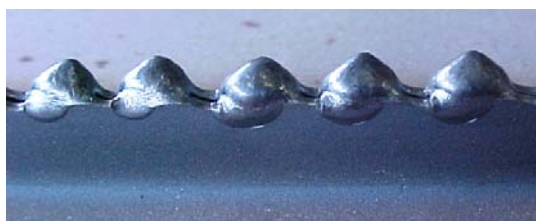
Figura 14.3: Aspecto geral dos cordões de solda resultantes da série 34-1
