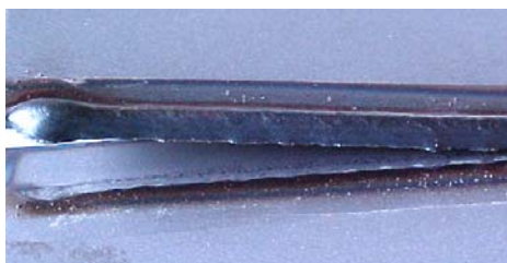
Figura 17.6: Corpo de prova reprovado por falta de fusão (baixa penetração)
