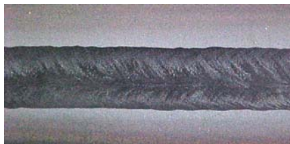
Figura 17.9: Aspecto dos cordões obtidos com TIG à máxima velocidade (A50 comercial)
