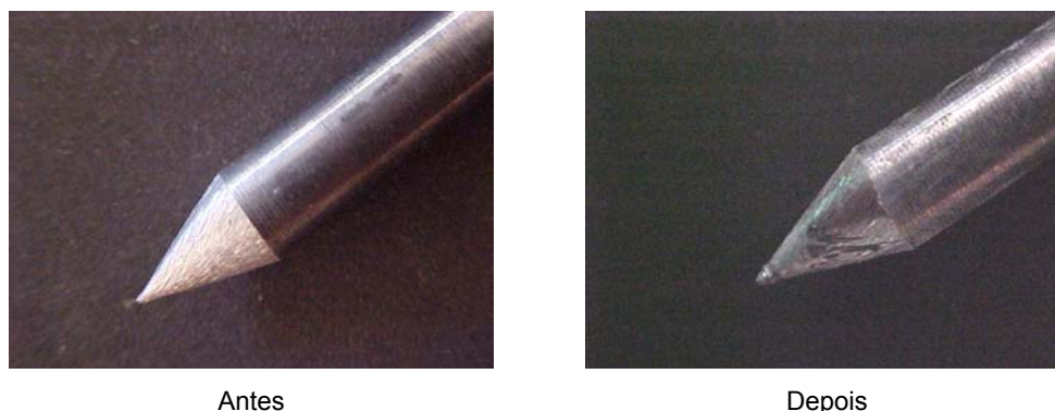
Figura 18.2: Eletrodo antes e depois da série de testes 45-1
