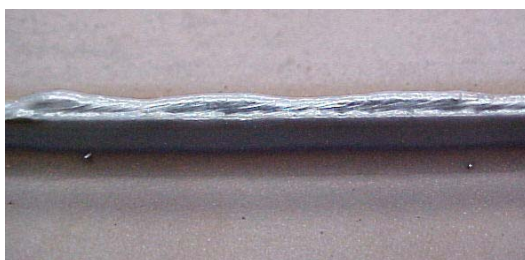
Figura 12.6: Aspecto dos cordões obtidos com MIG/MAG (testes 31-2-5, 31-2-6 e 31-2-7)
