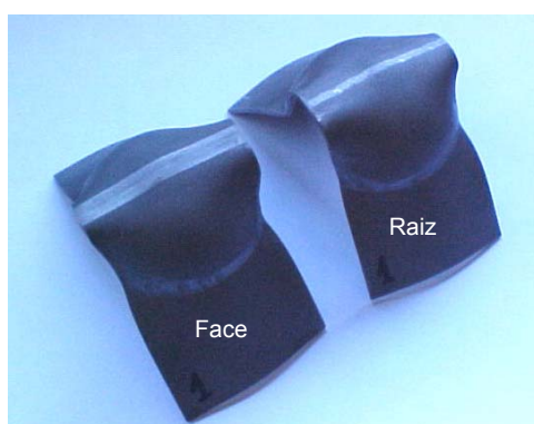
Face e raiz da solda com a mistura A50
