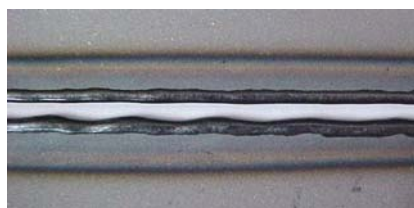
Figura 16.6: Aspecto característico dos cordões com abertura da junta de topo de 1 mm
