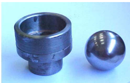
Figura 13.12: Anel e esfera utilizados no teste de estampabilidade improvisado
