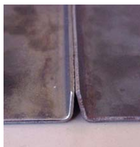
Figura 14.4: Forma da junta em aresta depois de feita uma pequena pré-deformação
