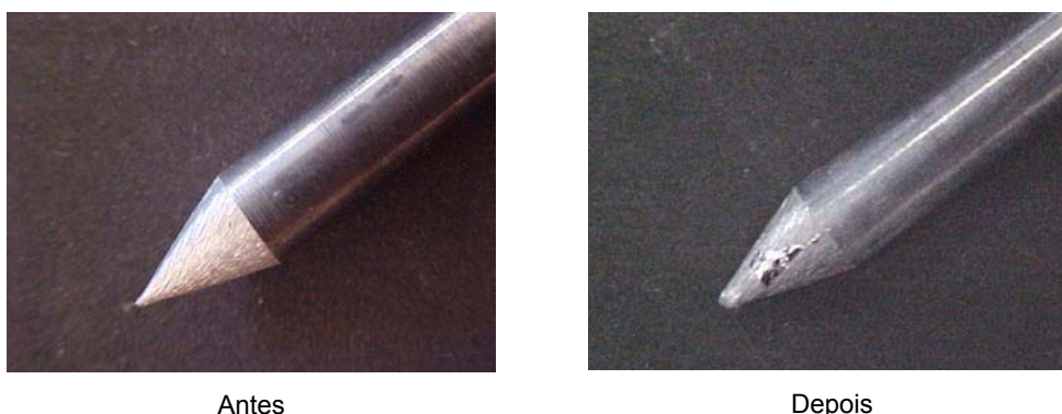
Figura 18.4: Eletrodo antes e depois da série de testes 46-1
