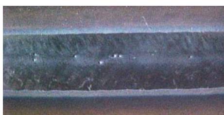
Figura 14.8: Junta sobreposta com poros (mistura A100 e elevada velocidade de soldagem)
