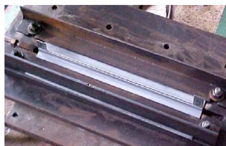
Figura 16.1: Esquema de fixação do espaçador e corpo de prova montado
