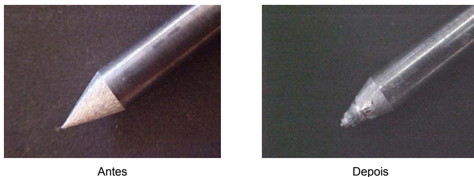
Figura 18.5: Eletrodo antes e depois da série de testes 46-2
