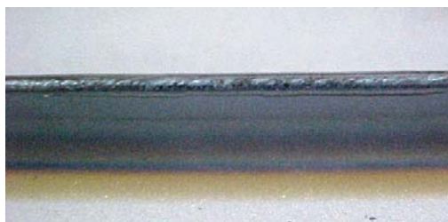
Figura 14.5: Aspecto do cordão obtido na velocidade de soldagem limite da série 34-4
