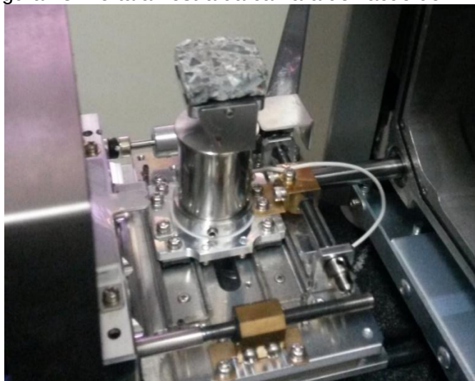
Figura 28: Porta amostra da câmara de vácuo do MEV.
