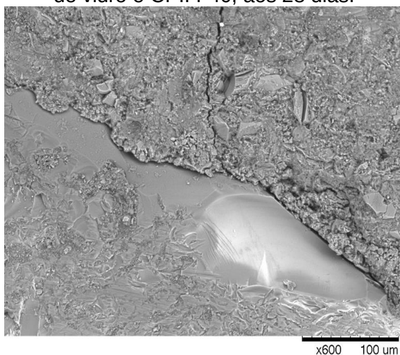
Figura 34: Interface entre o agregado e pasta da amostra produzida com resíduo de vidro e CII F40, aos 28 dias.
