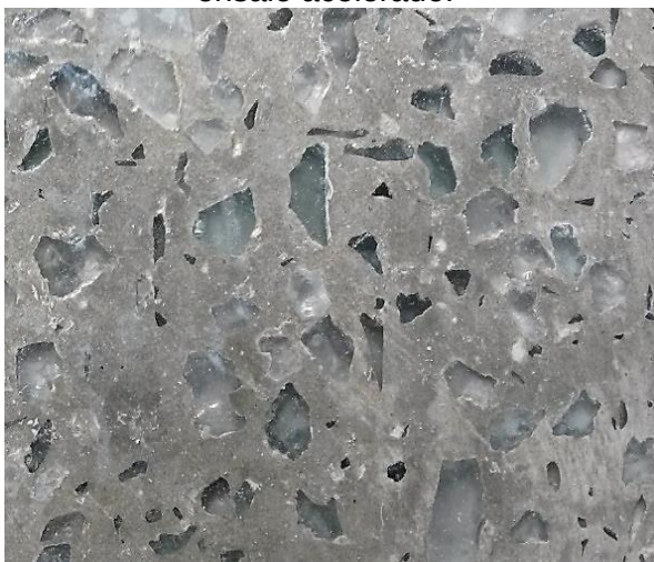
Figura 52: Superfície da amostra produzida com resíduo de vidro e CII F40, antes do ensaio acelerado.
