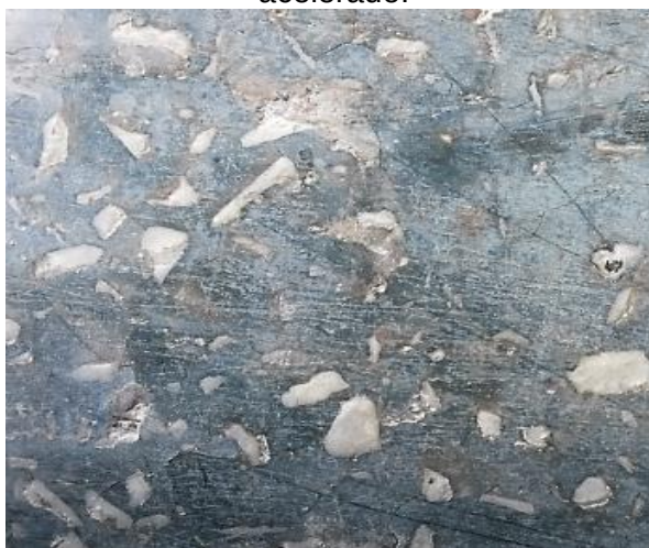
Figura 55: Superfície da amostra produzida com resíduo de vidro e CPIV 32, após ensaio acelerado.
