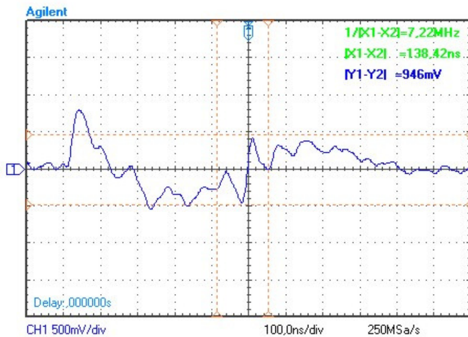
Figura 5.68 (a): Sinal na rede elétrica sem transmissão de dados, sem a presença de ruídos e com filtro.
