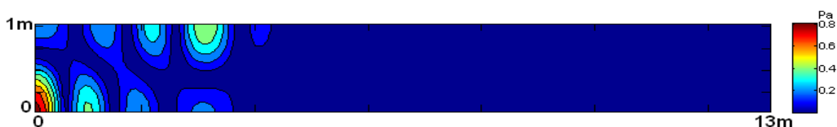
Figura 6.23.a – Campo sonoro (Pa) na freq. de 270 Hz após simulação do CAR com posição otimizada da fonte de controle e duto sem partição.
