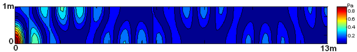
Figura 6.22.a – Campo sonoro (Pa) na freq. de 270 Hz gerado pela fonte primária no duto sem partições.
