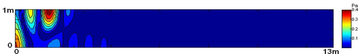
Figura 6.27.a – Campo sonoro (Pa) na freq. de 320 Hz após simulação do CAR com posição da fonte de controle otimizada e duto sem partições.
