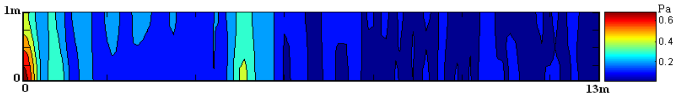
Figura 7.20a – Pressão acústica global no interior do duto com controle ativo de ruído utilizando onze fontes de controle.
