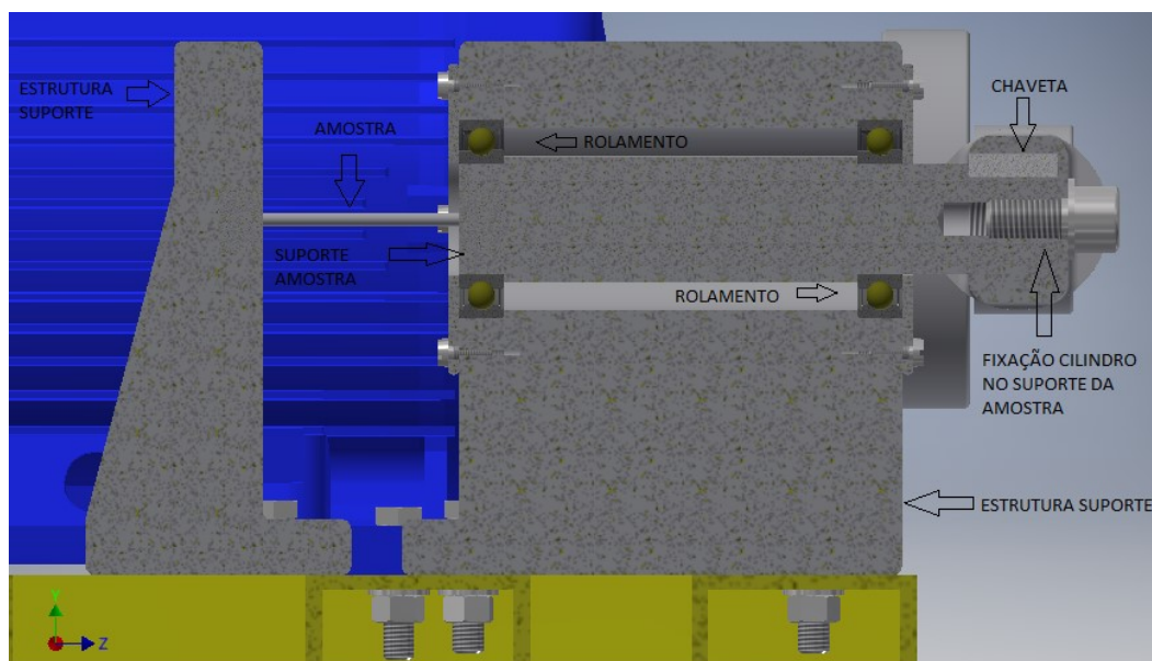
Figura 3. 27 - Vista em corte do mecanismo de suporte da amostra.
