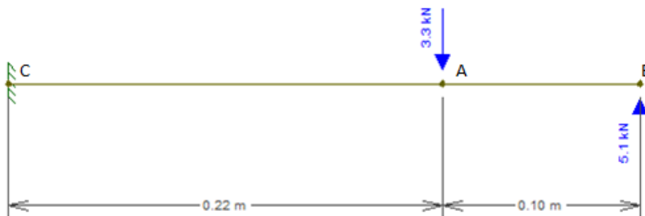
Figura 3. 14 - Diagrama de corpo livre camisa do cilindro mecânico.
