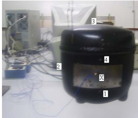
Figure 7.18– Structure instrumentée et points d'identification des FRFs expérimentales.
