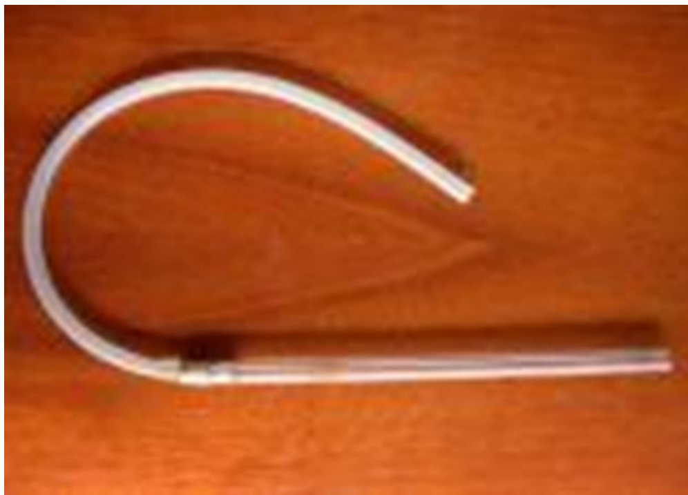
Foto 13: Tubo de sucção - Capturador de Castro. Autora: Vieira, G. S. da S., 2007.
