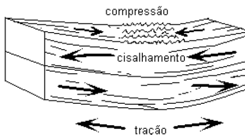
Figura 13 – Comportamento mecânico da madeira à flexão simples
