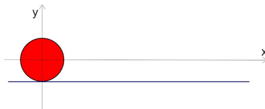
Figura 6.1: Roda de equação r(\theta) = 1 rola sobre caminho de equação y(x) = -1 .
