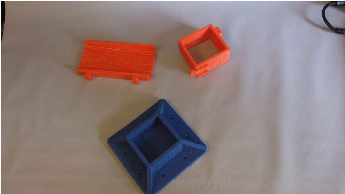
Figura 80. Peças refugadas por falhas da impressora [Fonte: próprio autor].
