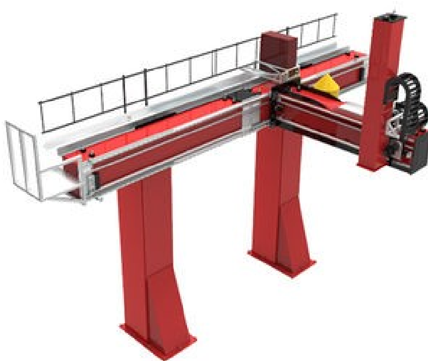
Figura 3. Robô cartesiano industrial [Fonte: https://goo.gl/VdmPVY ].
