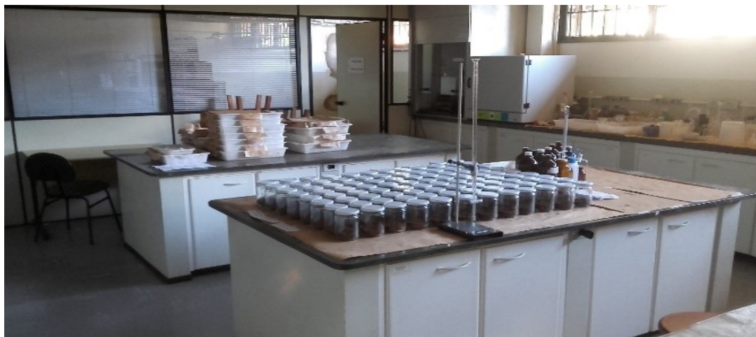
Figura 4. Ensaio de respiração microbiana montado no laboratório de Pedologia da Universidade Federal de Uberlândia.
