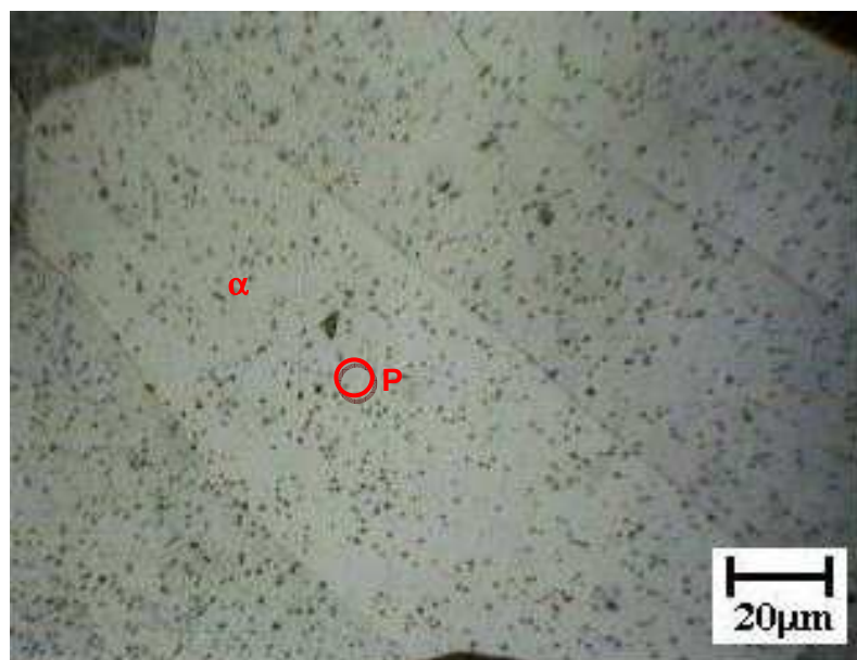
Figura 5.26. Zona fundida da placa de teste de metal de base UNS43932 soldado com o metal de adição ER430LNb e o gás de proteção Ar+2%O 2 (α) matriz ferrítica, (P) precipitados de nióbio
