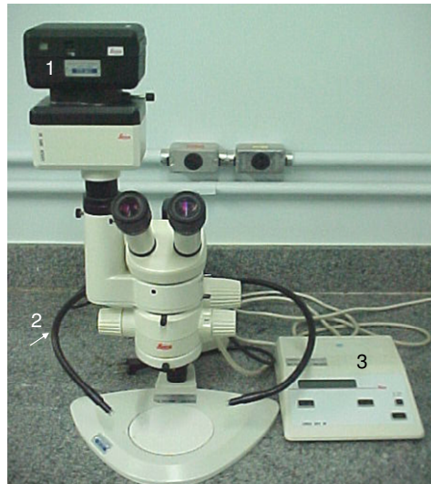
Figura 4. Lupa estereoscópica (1) dispositivo fotográfico; (2) fibra ótica para iluminação (seta branca); e (3) monitor para o controle fotográfico.
