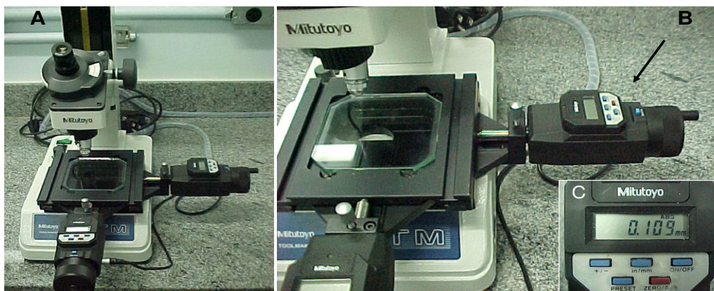
Figura 5. Microscópio de precisão. (A) vista panorâmica; (B) dispositivo de monitorização das medidas obtidas (seta preta); e (C) detalhe do visor com medidas em milímetros.
