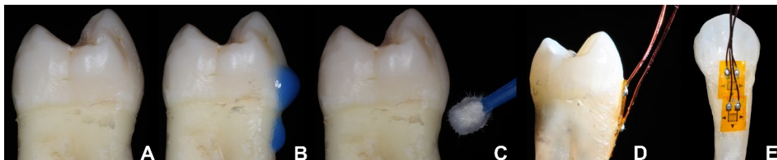
Figura 30: Colagem dos extensômetros radicular e coronário. A – Dente hígido selecionado. B – Condicionamento com ácido fosfórico nas regiões de fixação do extensômetro. C – Aplicação do adesivo de cianoacrilato. D e E – Extensômetros já posicionados.
