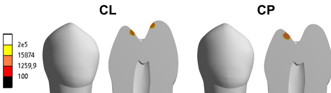
Figura 53: Análise do padrão do critério sobrevida para esmalte e dentina. Os valores significam a quantidade de ciclos que a estrutura deve receber para falhar, sendo representados pelas respectivas cores.
