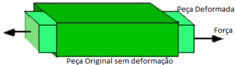
Figura 2.5-Exemplo de deformação lateral
