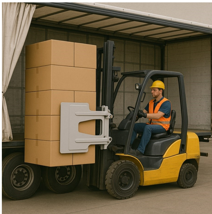
Figura 13 – Máquina Clamp retirando caixa de carreta
