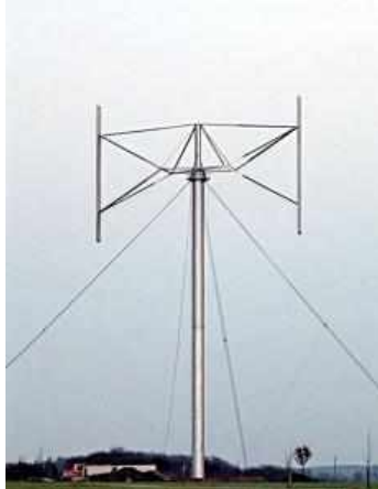
Figura 5 - Aerogerador de eixo vertical do tipo Giromill
