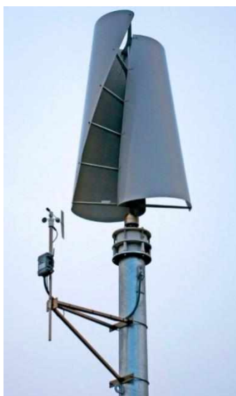
Figura 3 – Aerogerador de eixo vertical do tipo Savonius
