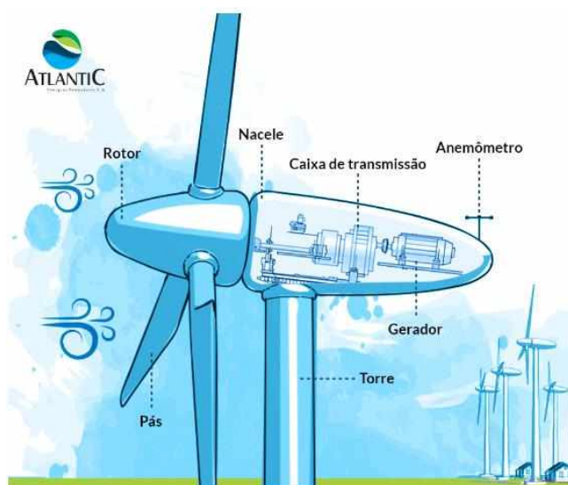
Figura 1 - Sistema eólico com seus componentes indicados
