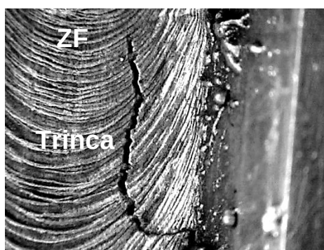
Figura 6.13 – Detalhe da trinca de hidrogênio na ZF do T7 (37,5X)
