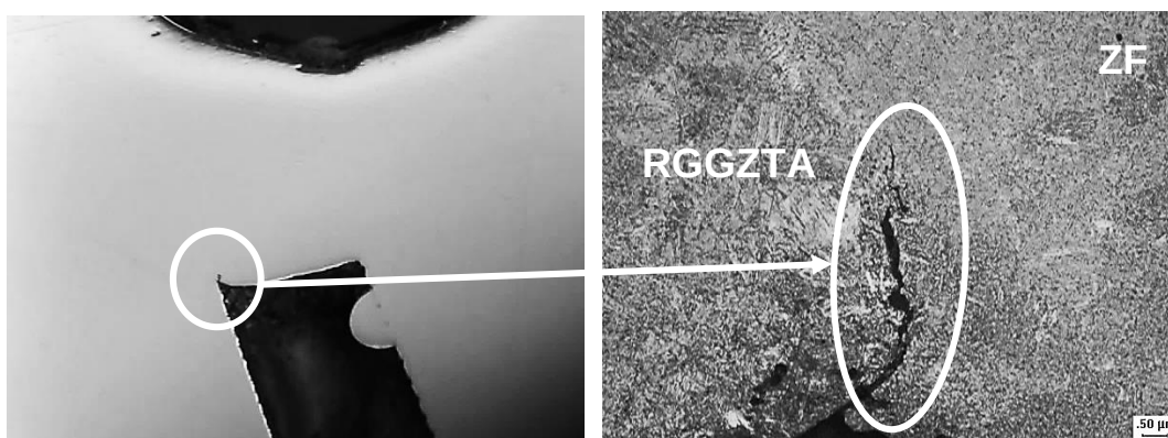
(a) (b) Figura 6.2 – Detalhe do T5. (a) macrografia mostrando detalhe da trinca, CP simplesmente polido. (37,5X); (b) detalhe da trinca de hidrogênio no entalhe na RGGZTA (200X)
