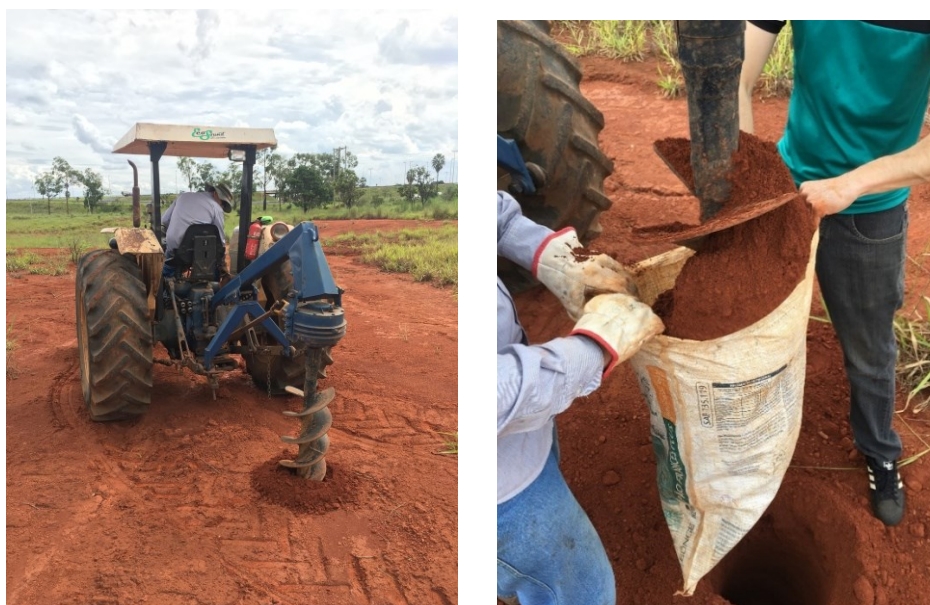
Figura 8 – Extração e coleta da amostra de solo.
