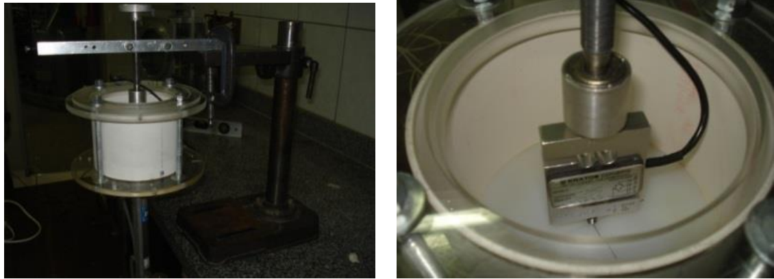
Figura 3.20 - a) Suporte montado na bancada. b) Posicionamento central da célula de carga
