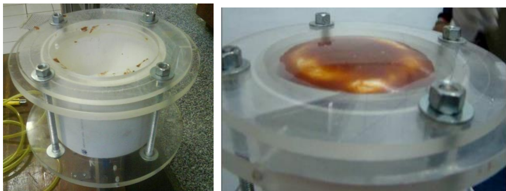
Figura 3.18 - Fixação das placas de acrílico, filme plástico e tubo através de parafusos
