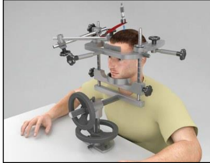
Figura 2.7 - Protótipo de equipamento para monitorar a pressão intracraniana de forma não invasiva. Fonte: Ciência Hoje On-line.
