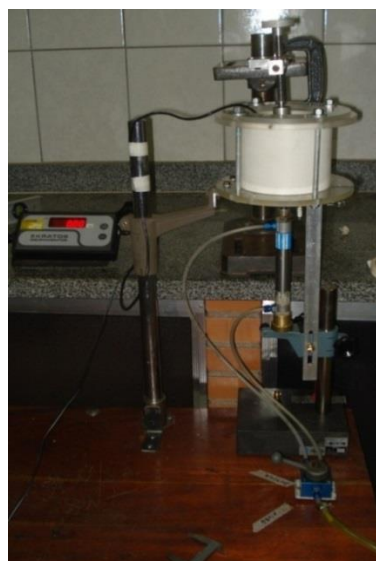
Figura 3.16 - Modelo mecânico durante a medida da força proporcionada pelo atuador pneumático
