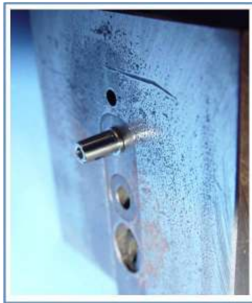
Figura 8. Posicionamento dos implantes do grupos CM2 com corpo submerso 1mm na estativa.
