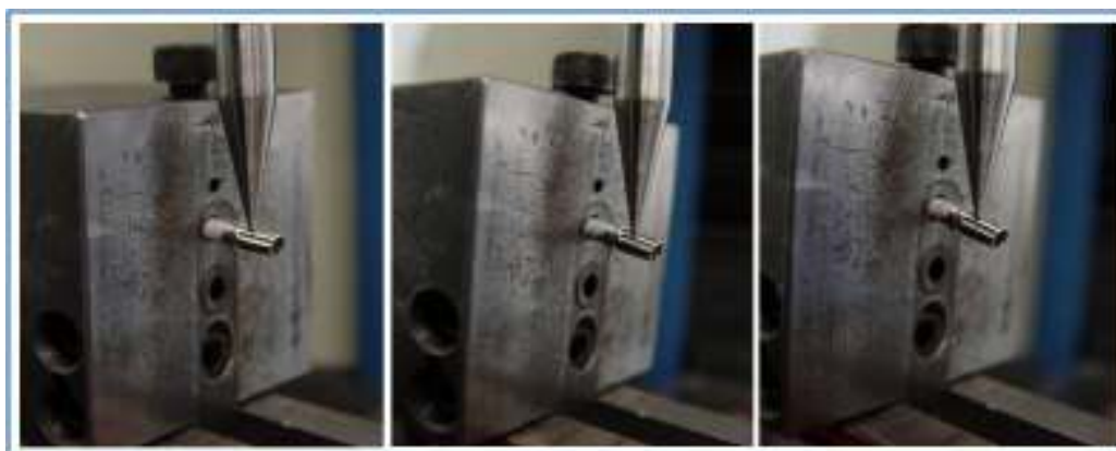
Figura 13. Ensaio mecânico até queda abrupta da resistência.
