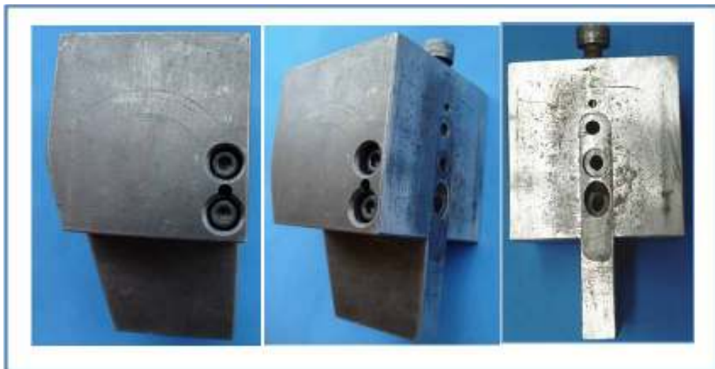
Figura 2. Dispositivo de aço para estabilização dos implantes – estativa: a) vista lateral, b) vista oblíqua e c) vista frontal.
