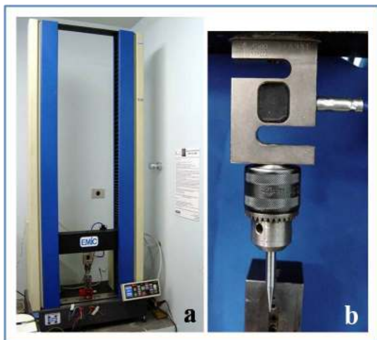
Figura 9. (a) máquina de ensaio mecânico (EMIC, 2000DL), (b) célula de carga de 500KN e ponta aplicadora acoplada.
