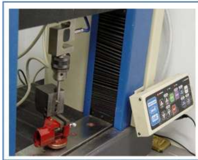
Figura 11. Conjunto pilar/implante submetido a carregamento de flexão.
