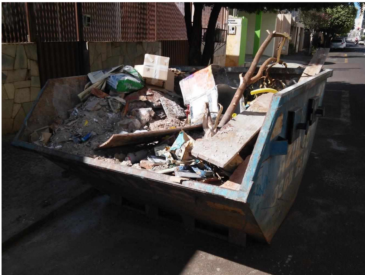
Figura 5: Caçamba destinada ao armazenamento de resíduos sólidos da construção civil, sendo usada também para destinação de materiais recicláveis.
