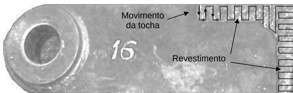
Figura 4.2 – Faca picadora destacando o movimento da tocha executado pelo soldador.
