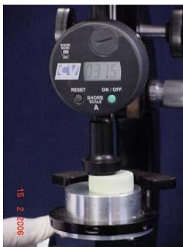
Figura 4.1.5 - Durômetro shore A (Shore Scale Durometer Hardness Tester, England) utilizado na mensuração da dureza do cilindro do simulador de alimento “Optocal”
