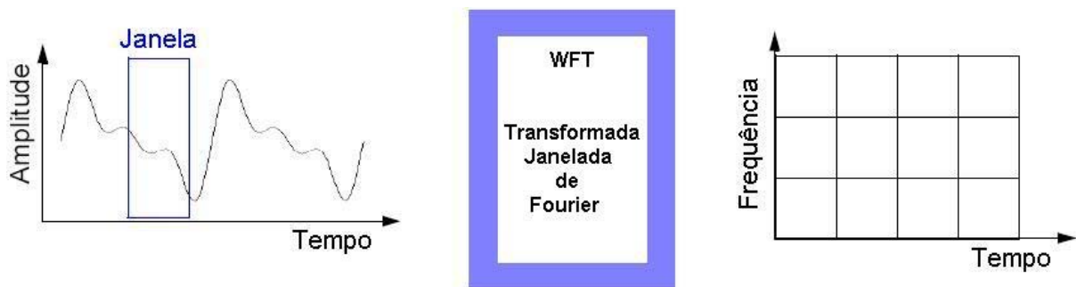
Figura 3.4 – Transformada Janelada de Fourier
