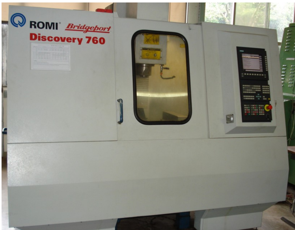
Figura 3.7 - Centro de usinagem vertical CNC utilizado no teste de usinagem no corte ortogonal
