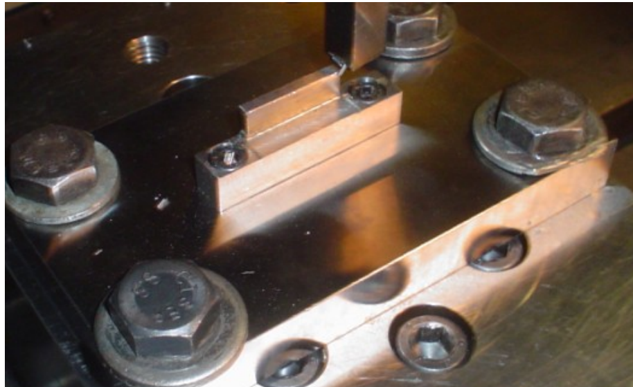
Figura 3.2 - Dispositivo desenvolvido e fixado no dinamômetro.
