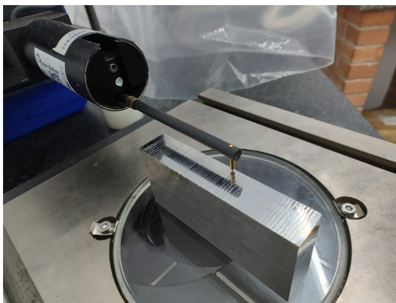
Figura 3.20. Medição da altura das rebarbas.
