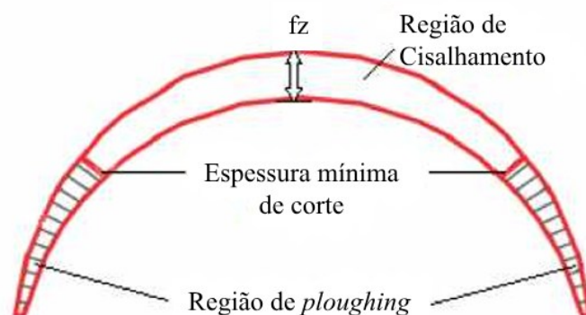
Figura 2.2. Variação da espessura de corte no microfresamento de topo, vista no plano de trabalho.
