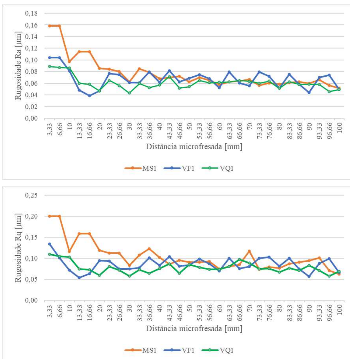
Figura 4.7. Rugosidades R_a e R_q para as 3 ferramentas no Teste 1.
