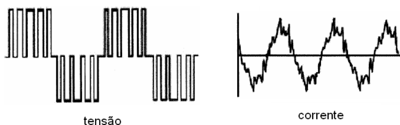
Figura 2.20 – Formas de onda típicas de saída do inversor
