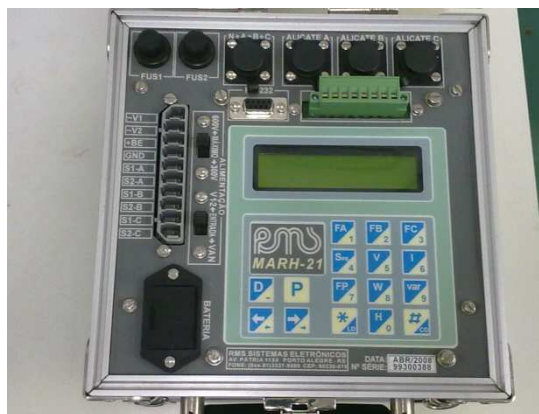
Figura 5.4 – Analisador de energia RMS MARH-21993
