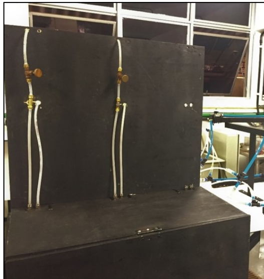
Figura 3.5 - Sistema de expulsão de ar da linha.
