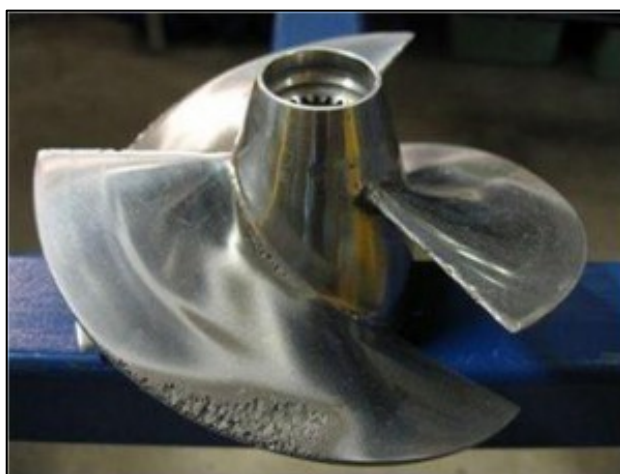
Figura 2.4 – Impulsor danificado pela ação da cavitação (MMTEC, 2017).
