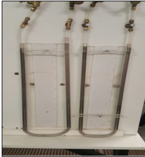
Figura 3.2 – Sistema de leitura de diferença de pressão nas bombas utilizando manômetros do tipo tubo em U.
