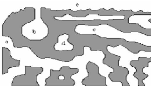
Figura 2.15– Seção ilustrativa de um sólido poroso com representação dos diferentes tipos de poro: (a), (b), (c) abertos, sendo (b) gargalo de garrafa, (c) cilíndrico; (d) fechado; (e) rugosidade da superfície ((FERREIRA; ALVES (2006)).
