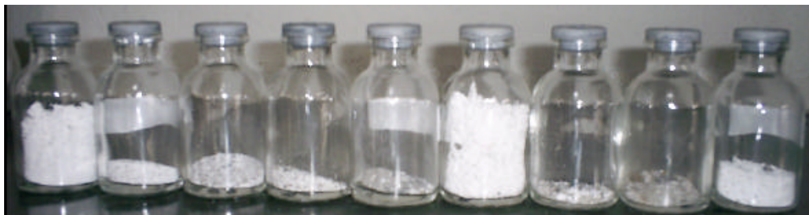
Figura 4.7 – Resíduo insolúvel de hidratação coletado em amostras obtidas com base em um planejamento fatorial de experimentos em dois níveis, resíduo coletado 3 horas após o término do ensaio.
