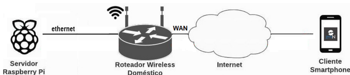
Figura 25 – Diagrama para conexão do cliente fora da rede doméstica sem VPN.
