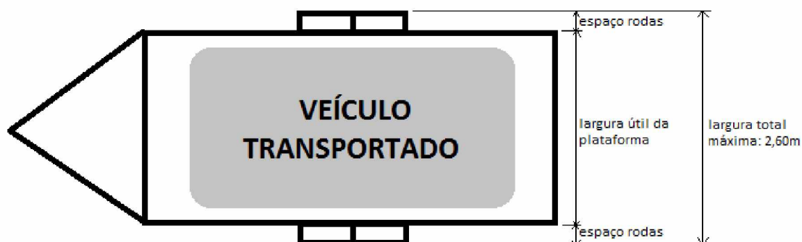
Figura 13. Dimensionamento da largura da plataforma.
