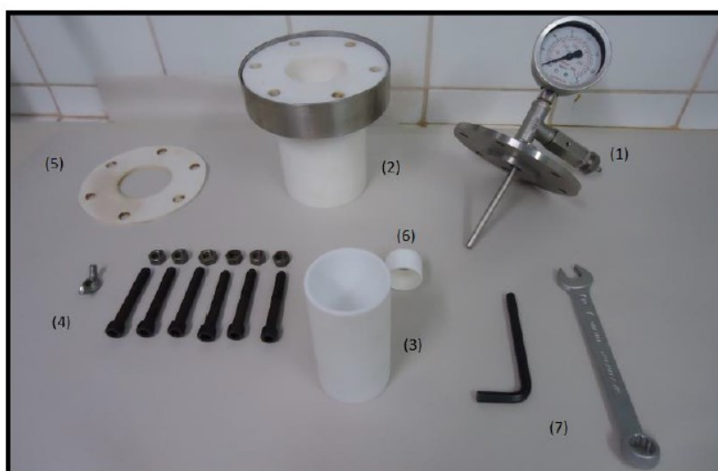
Figura 8. Acessórios utilizados no sistema hidrotérmico de micro-ondas. [1] Parte superior do reator (manômetro e válvula de segurança), [2] reator de teflon, [3] copo de teflon, [4] parafusos de encaixe e aterramento (“borboleta”), [5] borracha para a vedação, [6] fita vedarrosca, [7] ferramentas para vedação do reator.
