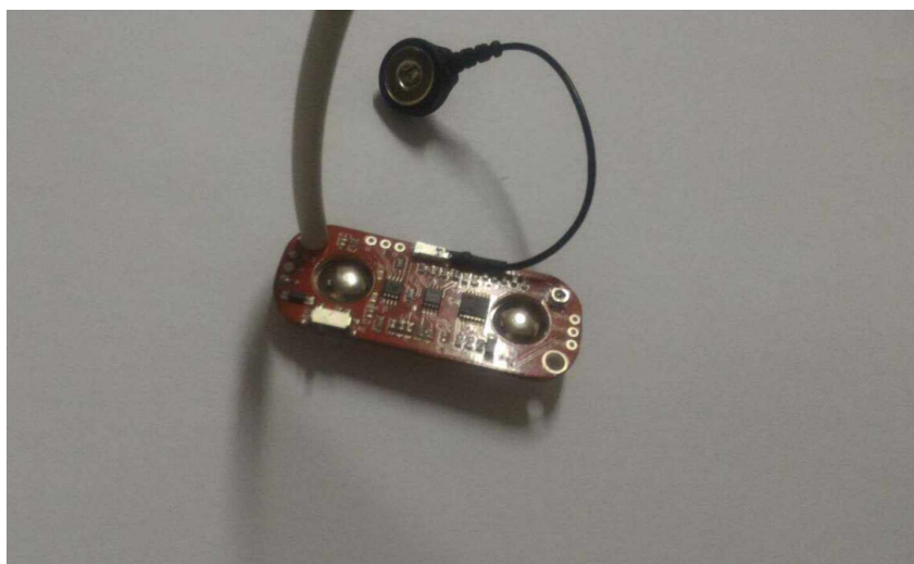
Figura 14 – Sensor Myoware com a sua referência
