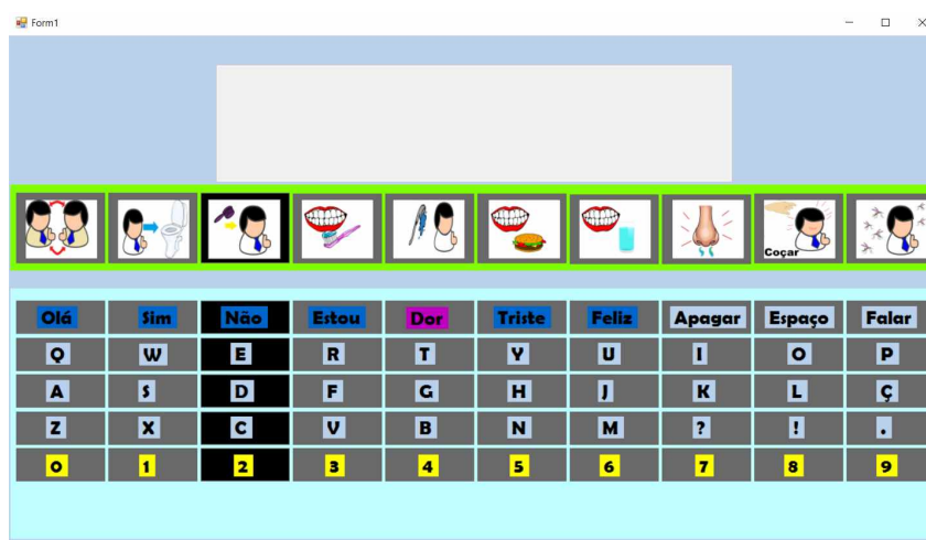
Figura 19 – Sistema de varredura: coluna à coluna
