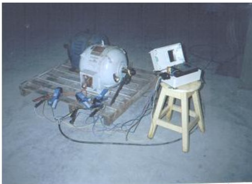
Figura III.4 – Ensaio do motor com rotor bloqueado.
