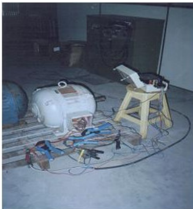
Figura III.2 – Ensaio do motor em vazio.
