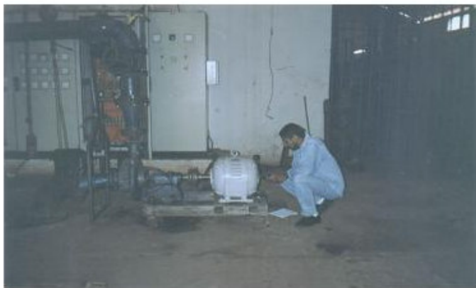
Figura III.10 – Ensaio do motor em carga.
